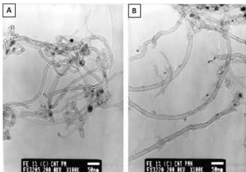
Figura 1. Imágenes TEM de los nanotubos de carbono, empleados como soportes de catalizadores, obtenidos por descomposición catalítica de C_2H_2 : (A) Purificados con HF; (B) Purificados con HF + NNO_3 . [F.R. García-García et al., Catalysis Today , 133–135 , 815–821 (2008).]
