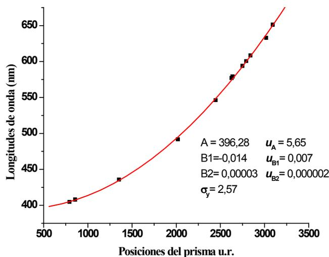
Figura 2. Curva para calibrar el prisma.
