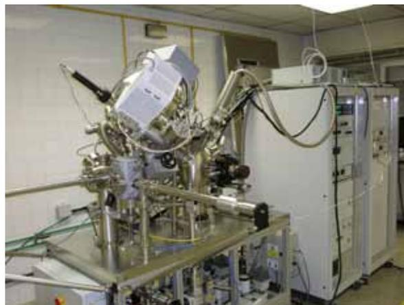
Figura 2. Fotografía de los sistemas de UHV, disponibles en la UNED, donde se realizan los análisis de materiales por espectroscopias fotoelectrónica de rayos X (XPS) y de electrones Auger (AES), así como de espectrometría de masas de iones secundarios (SIMS).
