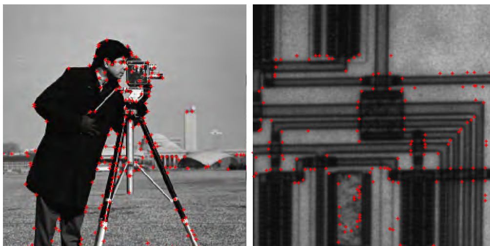
FIGURA 9: Puntos de interés sobre las imágenes predefinidas de Matlab cameraman (izquierda) y circuit (derecha) obtenidas mediante el detector de Harris.
