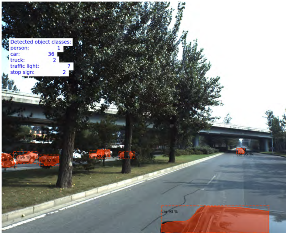
FIGURA 5.29. Recuento de objetos: algoritmo inicial sin mejoras, 50 imágenes y un límite de detección del 85%
