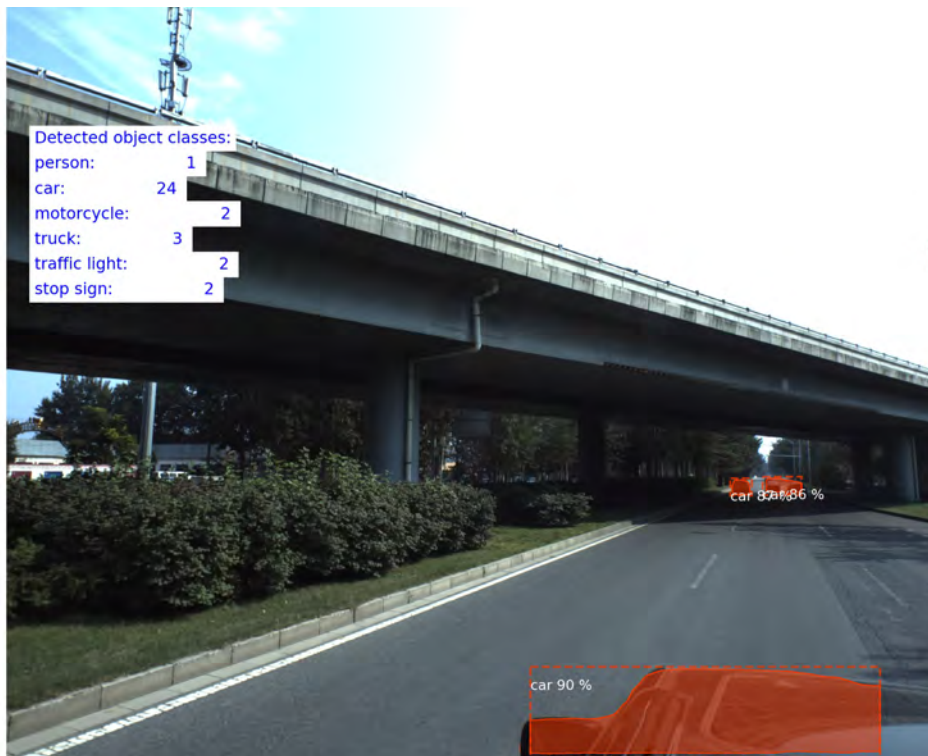
FIGURA 5.31. Recuento de objetos: algoritmo mejorado con detección de posición, 50 imágenes y un límite de detección del 85%
