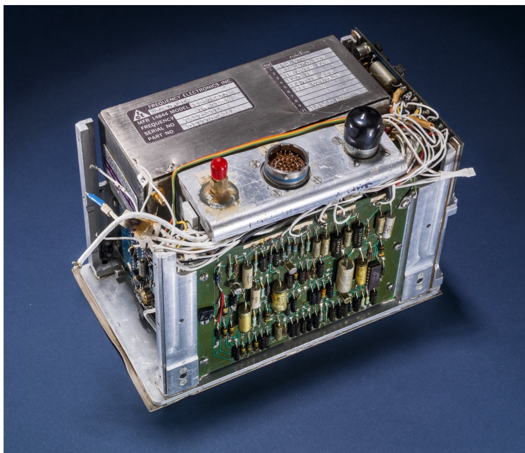
Figura 4.2: Reloj atómico a bordo de los satélites GPS. Es el componente más crítico de todo el satélite. Fuente: NASA.
