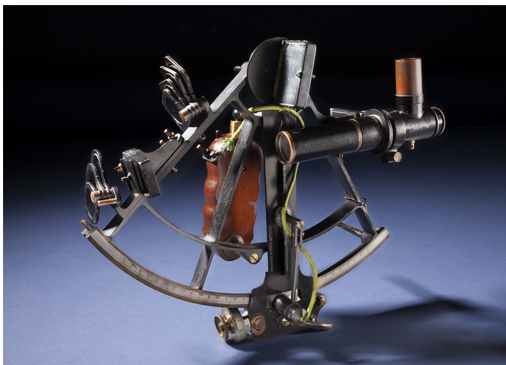
Figura 3.6: Fabricado por Brandis & Sons Inc. Un sextante marítimo con un accesorio de burbuja especial en el ocular para ayudar a establecer un horizonte en uso aeronáutico, alrededor de 1919. Fuente: National Air and Space Museum.
