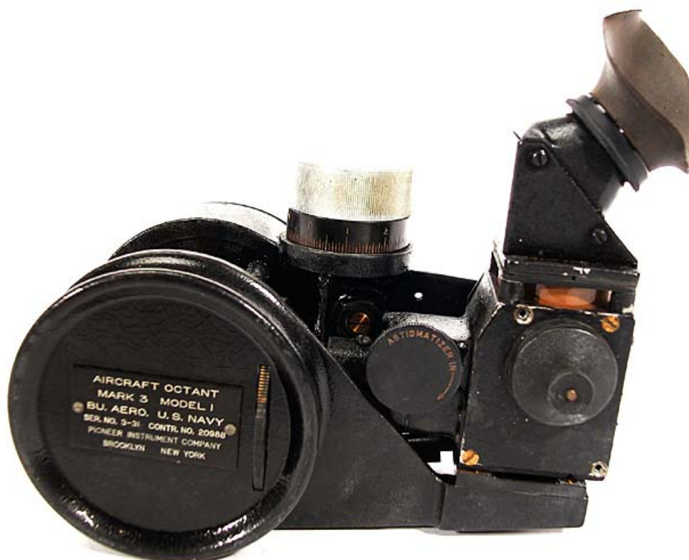
Figura 3.11: Octante de aviación marca Pioneer modelo 342. Charles y Anne Lindbergh utilizaron este instrumento en 1933 cuando inspeccionaron las rutas aéreas a través y alrededor del Atlántico para Pan American Airways. Anne había estudiado recientemente navegación celeste, y las notas del reverso son probablemente de su mano. Los números de serie indican que éste era el tercer ejemplar del modelo 342, y el tercero fabricado para la Marina en 1931. Colección del National Museum of American History
