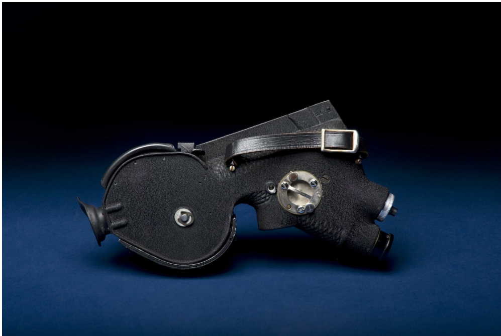
Figura 3.14: Sextante de burbuja modelo Link A12. Es un sextante anterior a la Segunda Guerra Mundial fabricado por la Link Aviation Co. Fue utilizado por los militares y las aerolíneas hasta finales de la década de 1940, y fue el último de una línea de sextantes para aviones cuyo diseño fue influenciado por el uso en aviones de cabina abierta. Fuente: National Air and Space Museum, Smithsonian Institution.
