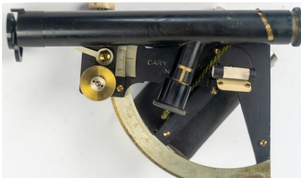
Figura 3.4: Octante para globo o aerostato tipo Cary-Porter. En realidad, este instrumento sólo puede medir hasta 90 grados y, de hecho, ni siquiera es un sextante, sino técnicamente un clinómetro . Sin embargo, se utilizaba para las observaciones astronómicas y puede considerarse como el predecesor del sextante de burbuja. El telescopio tiene un espejo que mira hacia un pequeño nivel de burbuja montado en el limbo del índice. De este modo se puede determinar el ángulo vertical con respecto a la horizontal. Al igual que un sextante de tambor, este instrumento tiene un borde dentado, así como un micrómetro y una abrazadera de liberación rápida. En la parte superior del telescopio hay un juego de filtros. El instrumento se puede iluminar para usarlo de noche y lleva una pila en el mango. Además de un botón, el mango también tiene un potenciómetro para ajustar la cantidad de luz. Fuente: National Air and Space Museum.
