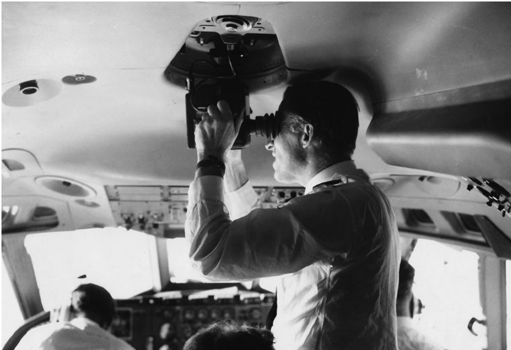
Figura 3.13: Sextante periscópico en un avión comercial Vickers VC-10. Fuente BOAC.
