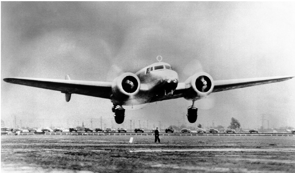
Figura 3.18: Avión Lockheed Electra 10E. Pilotado por Amelia Earhart en su fallido vuelo alrededor del mundo en 1937. La antena circular del goniómetro es claramente visible en la parte superior delantera del fuselaje. (Foto. AP press)
