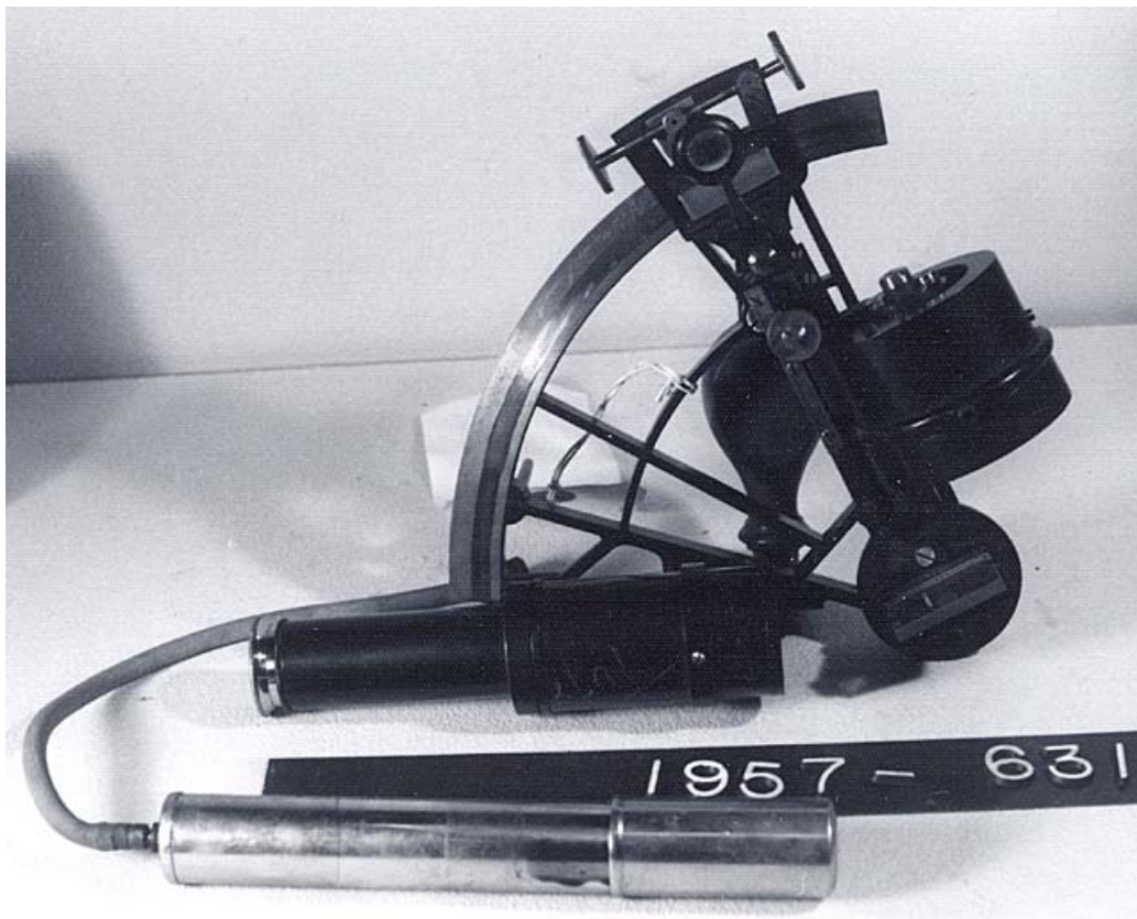
Figura 3.5: Sextante giroscópico, fabricado en Francia después de la primera guerra mundial. Fuente: Museo nacional del Aire y del Espacio, Francia.
