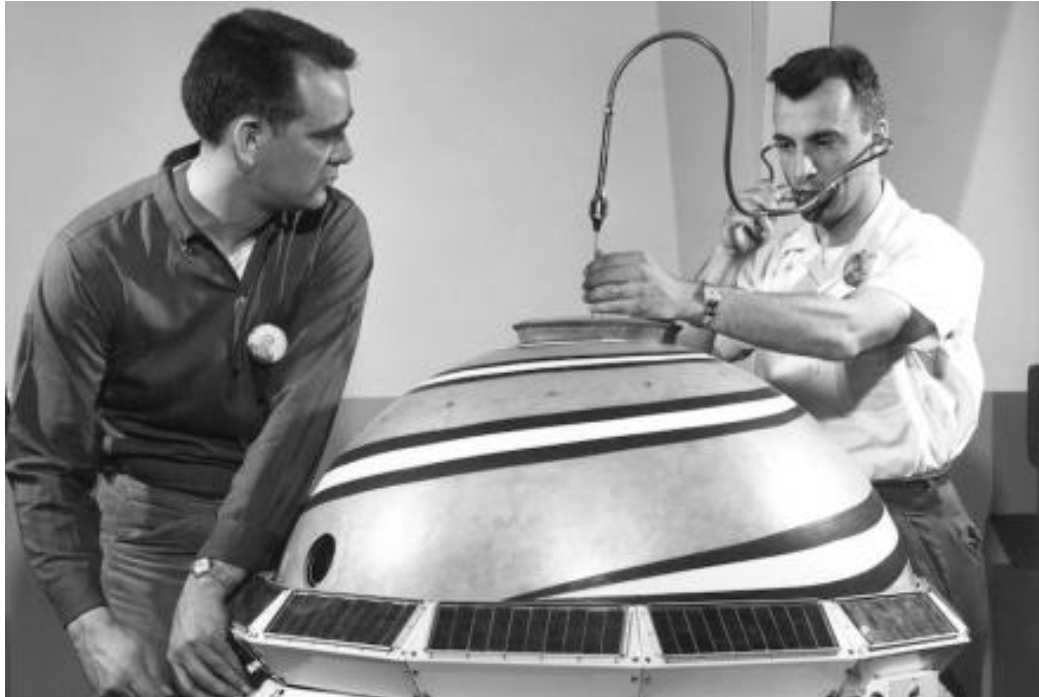
Figura 4.1: Satélite Transit. Dos técnicos del John Hopkins University Applied Physics Laboratory comprueban el segundo satélite Transit antes de su lanzamiento el 13 de Abril de 1960. Puede observarse el estetoscopio con el que se comprueba que el temporizador del satélite está operando. Las franjas alrededor del satélite ayudaban a controlar su temperatura (Fuente: NASA).
