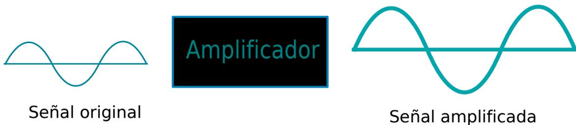
**Figura No. 12:** Resultado en magnitud de la señal original al ser sometida a un proceso de amplificación para brindarle potencia a la señal.
