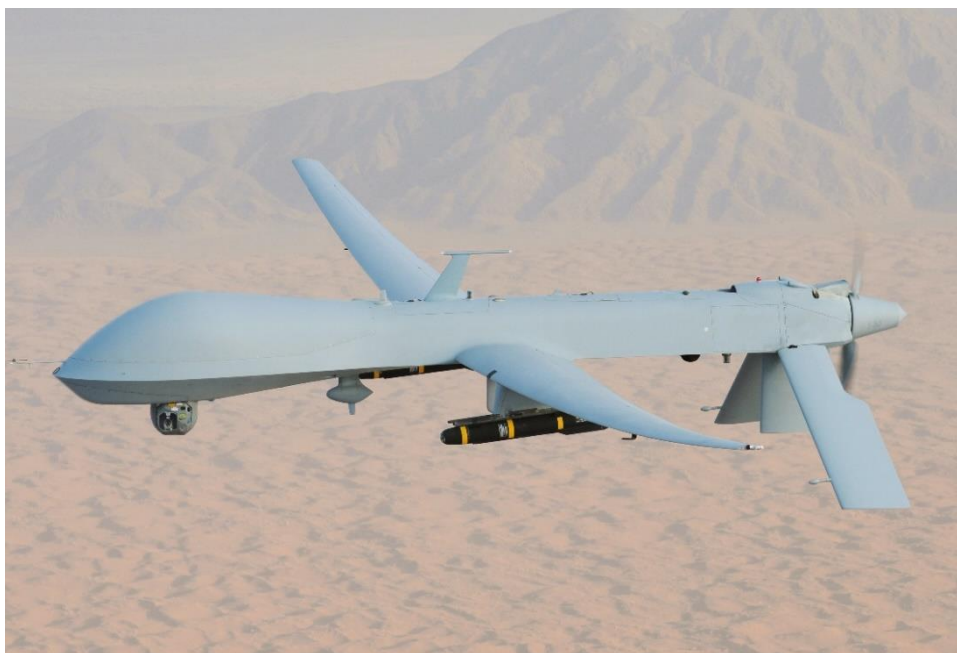
Ilustración 8: MQ-1 Predator, dotado con un AGM 114 Hellfire
