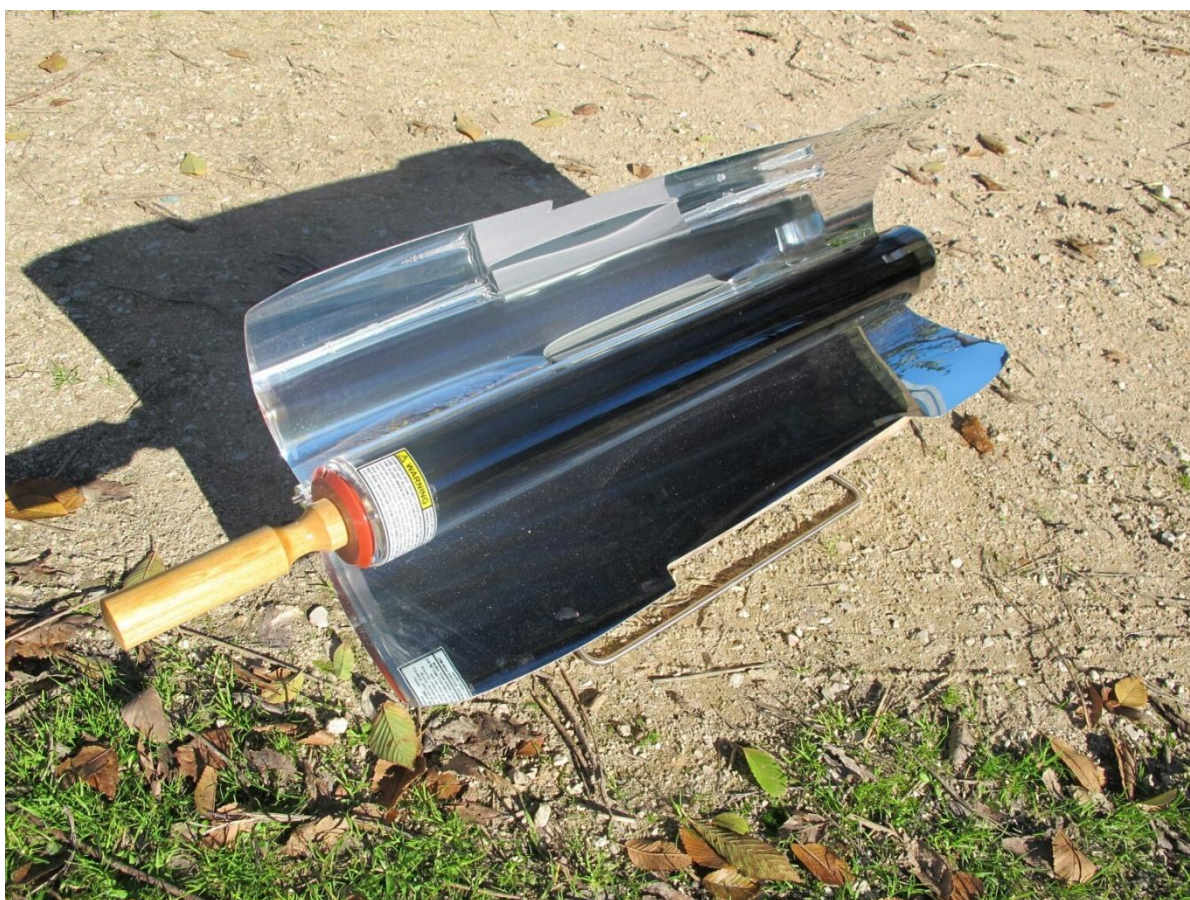
Ilustración 31. Horno solar, desarrollado por un huertano.
