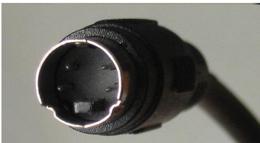
A la izquierda, un conector S VIDEO; a la derecha, un conector RCA
