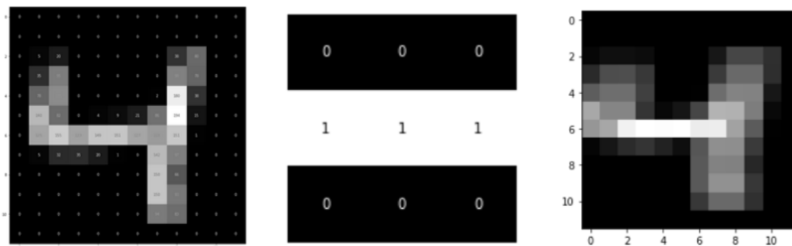
Figura 5 Convolución con filtro de tamaño 3 \times 3 para detección de bordes horizontales.
