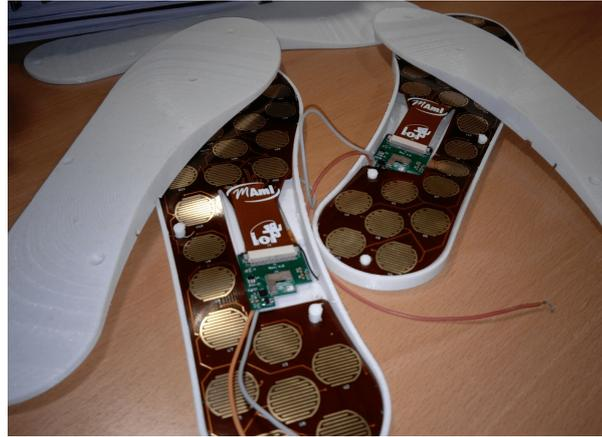
(b) Plantillas instrumentadas para el análisis de la marcha
