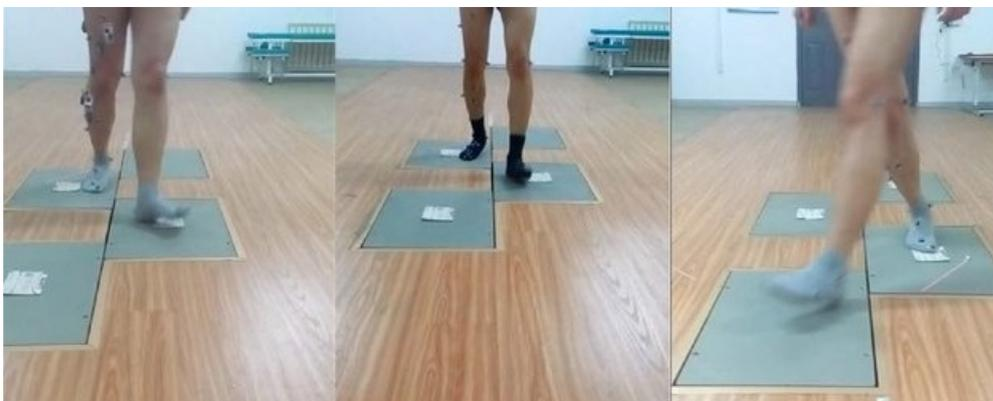
**Figura 3.16:** Cuatro plataformas de fuerza colocadas de manera consecutiva para el análisis de la marcha. Imagen tomada de [78]
