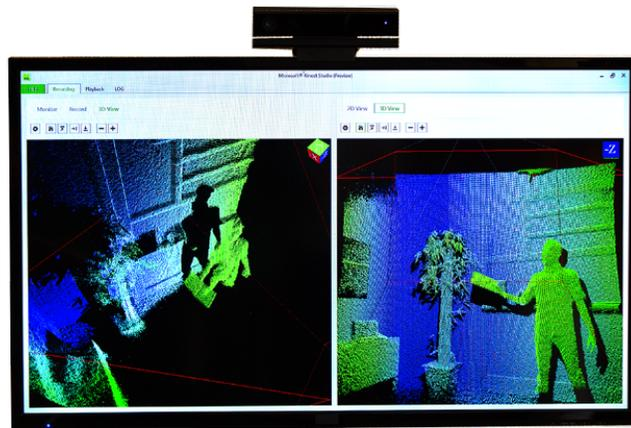
Figura 4.6: Ejemplo de vídeo capturado por el sensor Kinect. <sup>2</sup>
