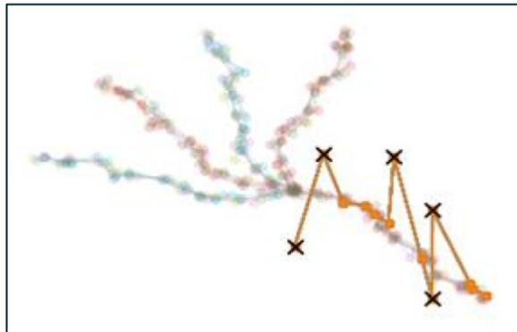
Ilustración 26. Ejemplo de detección de posiciones anómalas comunicadas por un dispositivo GPS. Los puntos marcados con una "X" representan las anomalías identificadas por el algoritmo de detección de la Toolbox.
