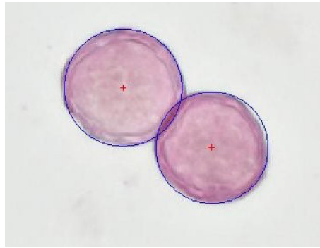
Figura 4.10: Segmentación mediante Transformada de Hough de granos adyacentes
