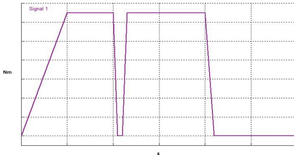
*Ilustración 13: Gráfica del par de entrada normalizado en el rotor utilizado en la simulación: arranque en rampa, reacción del control a la pérdida de red y parada.*
