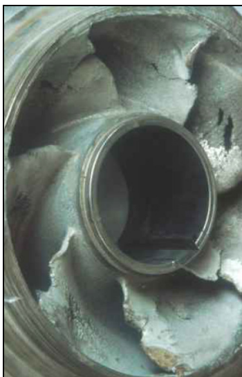
Figura 5.14. Daño causado sobre el lado de succión de un impulsor debido a la cavitación
