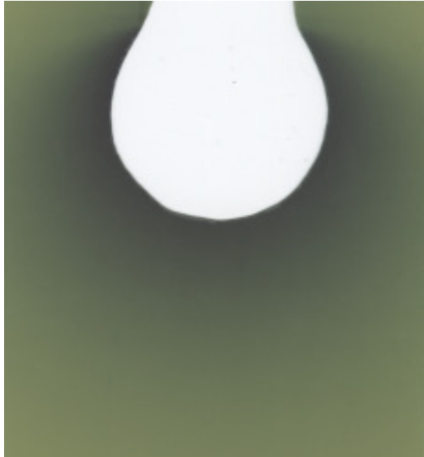
Figura D.2: Perfiles bidimensionales en película radiocrómica para el aplicador SP40
