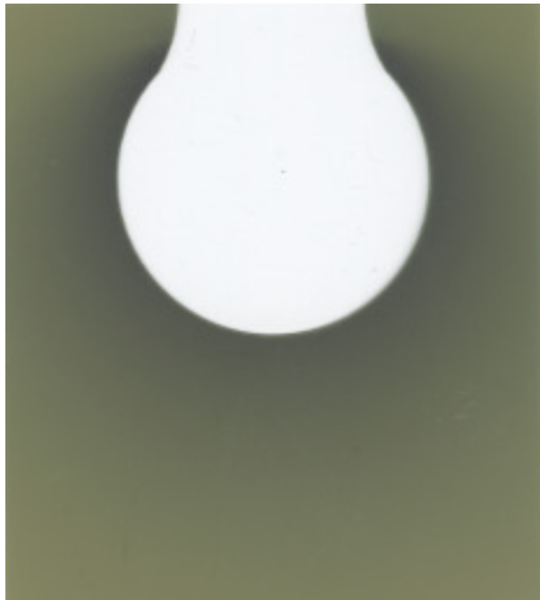
Figura D.3: Perfiles bidimensionales en película radiocrómica para el aplicador SP45
