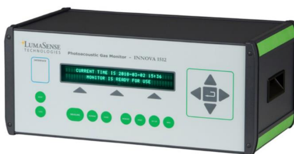
Figura 7. Monitor multigas fotoacústico (LumaSense Technologies® INNOVA 1512).
