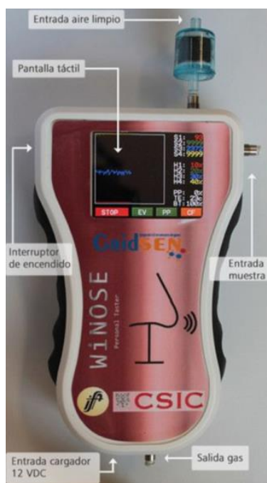
Figura 6. Nariz electrónica (Santos et al., 2012).
