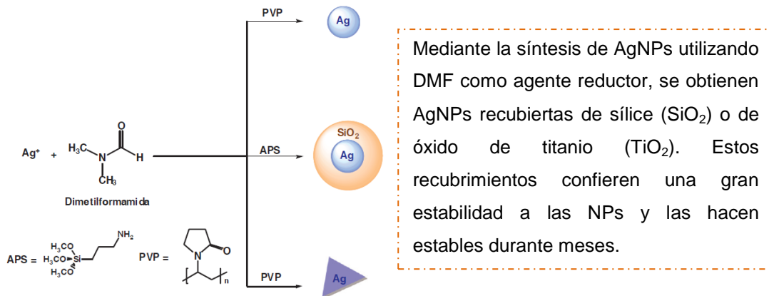
Figura 9: Síntesis de AgNPs empleando DMF como agente reductor. El empleo del polímero PVP da como resultado NPs o nanoprismas de Ag. Cuando se emplean APS se obtienen AgNPs rodeadas de una capa de sílice. Figura y nota tomada de [39].
