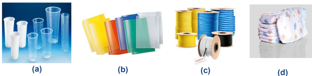
Figura 7: Material de polipropileno empleado en vasos (a), fundas (b), cuerdas (c) y pañales desechables (d) 37-40
