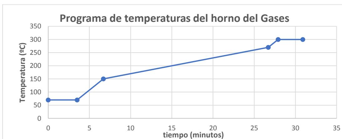
Figura 26. Programa de temperaturas del horno para el cromatógrafo de gases.
