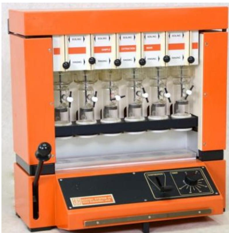
**Fig. 7.** Modelo de un equipo Soxtec 1043HT
