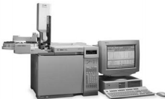
**Fig. 9.** Equipo de GC Agilent 6890 (Tomado de <https://www.agilent.com/>, acceso 09 de Junio de 2018)
