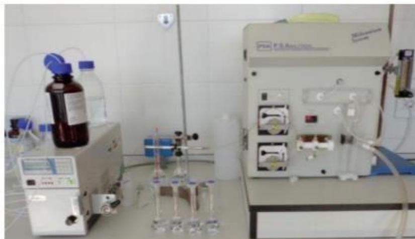
**Figura 18.** Acoplamiento HPLC-HG-AFS (Sánchez-Rodas, 2018).
