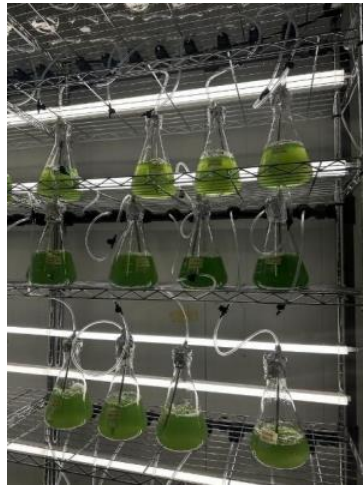
Figura 4. Escalado de A. platensis en matraz tipo Erlenmeyer desde 250 mL a 2000 mL. Tomada por Algaloop SL
