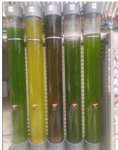
Figura 5. Fotobiorreactores de 100 L en los que se ha escalado de cultivo y adaptado a condiciones de luminosidad y temperatura para las tres especies de microalgas. tomada por Algaloop SL
