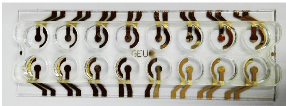
Figura 15. Sensores de oro con pocillos delimitados por una lámina de policarbonato.
