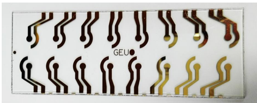
Figura 14. Sensores de oro diseñados por el grupo de Electroanálisis de la Universidad de Oviedo.
