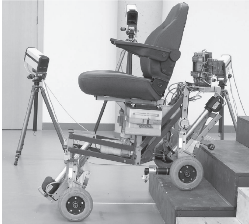
Fig. 10. Dispositivo experimental para la captura de trayectorias.
