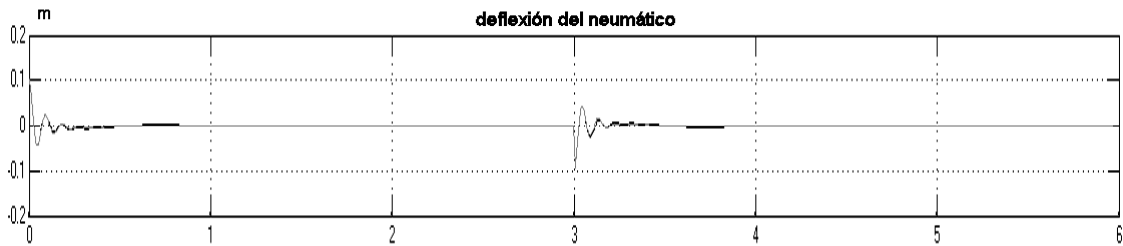
Fig. 6. Respuestas de la deflexión del neumático con suspensión pasiva (línea negra) y suspensión semi-activa (línea gris) en terreno regular.
