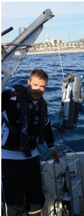
Figura3: Jaula del CTD con los sensores medioambientales y botella Niskin montados en la grúa para el muestreo del perfil de la columna de agua
