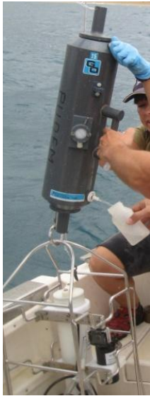
Figura5: Toma de muestra de agua de profundidad con botella Niskin.
