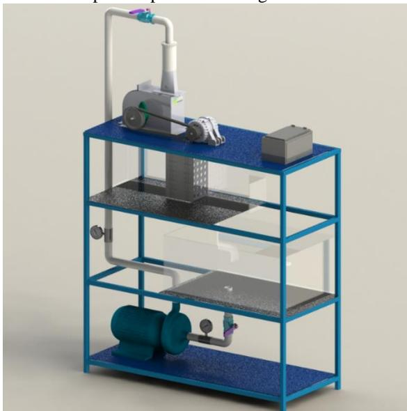
Figura 6. Banco de laboratorio Turbina Michell-Banki. Fuente: elaboración propia.
