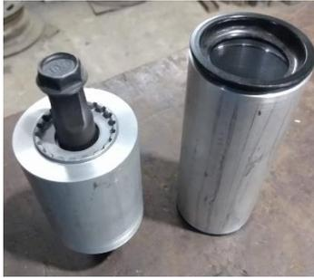
**Figura 20.** Caja de pedalier y columna de dirección mecanizados. Fuente: elaboración propia.
