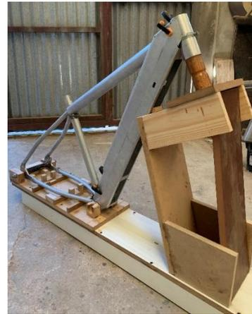
**Figura 25.** Piezas del cuadro presentadas sobre dispositivo de soldadura. Fuente: elaboración propia.
