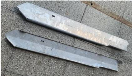
**Figura 21.** Plegado de chapas para caja de baterías y controlador. Fuente: elaboración propia.
