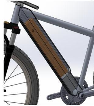
**Figura 1.** Disposición de las baterías de litio y el controlador en el cuadro. Fuente: elaboración propia.
