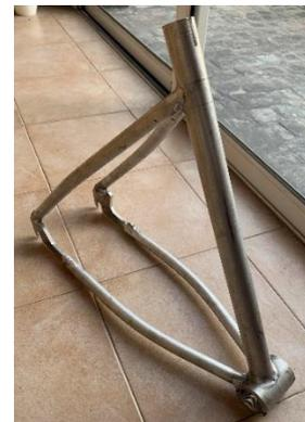
**Figura 26.** Horquilla trasera soldada. Fuente: elaboración propia.
