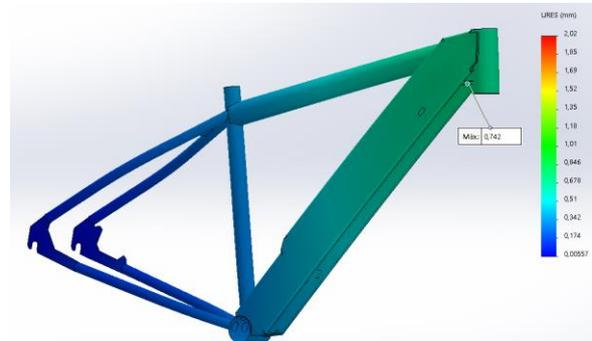
**Figura 18.** Ensayo de fatiga para fuerzas horizontales – desplazamientos. Fuente: elaboración propia.
