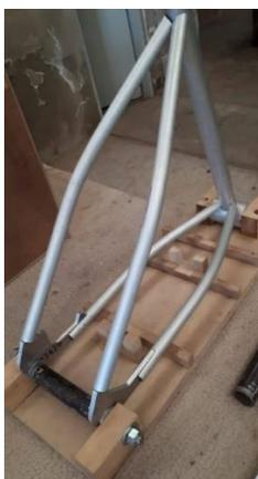
**Figura 24.** Piezas de horquilla trasera presentadas sobre dispositivo de soldadura. Fuente: elaboración propia.
