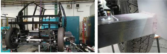
Figura 11. Izq: vehículo durante el ensayo de fatiga; Der: inspección de nodos críticos de la estructura
