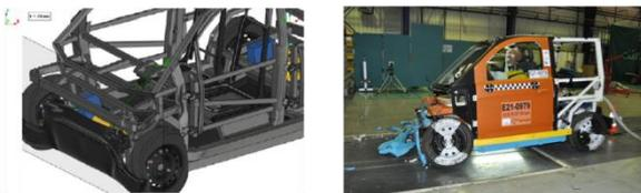
Figura 12. Vehículo impactado inmediatamente después del ensayo correspondiente a la Regulación 137. Izquierda: simulación; derecha: ensayo
