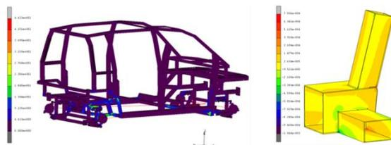
Figura 9. Izq: tensiones equivalentes de von Mises durante el ensayo de durabilidad; Der: deformaciones en el nodo crítico de la estructura
