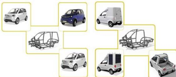
Figura 1. Concepto de modularidad: mínimos cambios en la estructura, diferentes tipologías de vehículo
