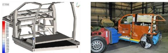
Figura 15. Vehículo después del ensayo correspondiente a la Regulación 95. Izquierda: simulación; derecha: ensayo
