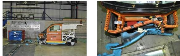
Figura 13. Vehículo tras el ensayo correspondiente a la Regulación 94. Izquierda: vehículo completo tras el ensayo; derecha: detalle del estado de la parte frontal de la estructura tras el ensayo
