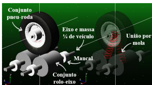
Figura 4. Modelo em MSC ADAMS® de 2 rolos e 1 pneu. Fonte: Elaboração própria.
