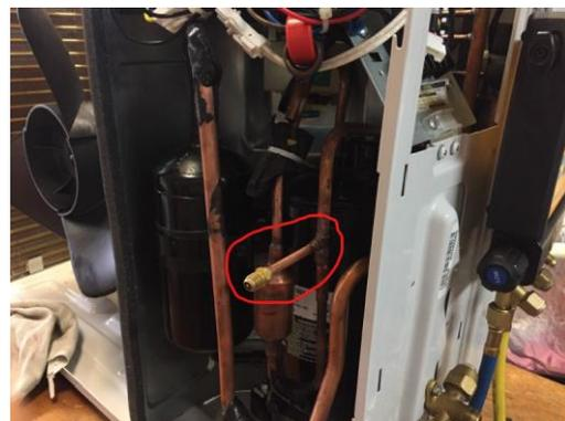
Figura 2. Adaptación de válvula presión de alta [18].
