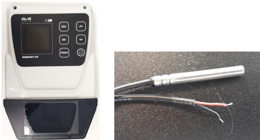
Figura 3. Registrador monolítico con sonda de temperatura externa. Fuente: TESTO https://www.testo.com/es-ES/aplicaciones/instrumentos-para-controlar-la-cadena-de-frio .
