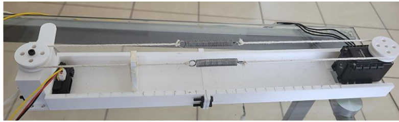
Figura 5. Prototipo del actuador de rigidez variable. Fuente: Elaboración propia
