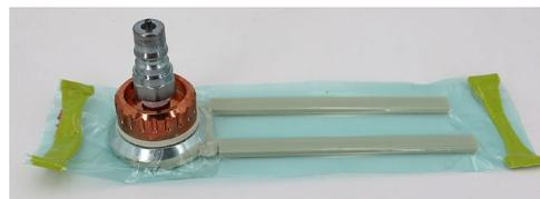
**Figura 1.** Montaje para la aplicación de presión durante el tratamiento térmico. Fuente: Elaboración propia.
