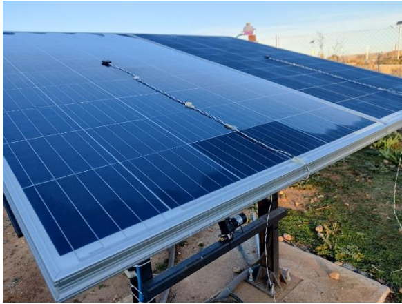
Figura 10. Fotografía tomada antes de comenzar el ensayo del 17 de noviembre donde se aprecia la formación de escarcha solo en el panel estándar (dcha.)
