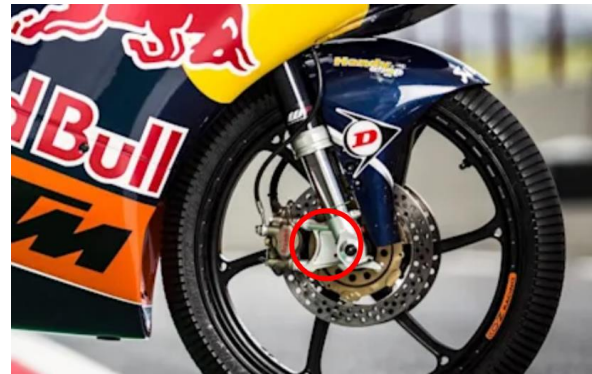
Figura 1. Ubicación del pie de horquilla (señalado en rojo) en prototipo KTM Moto3
