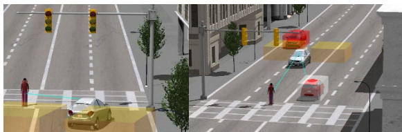
Figura 6. Simulación del sistema OPREVU-AES para peatón acelerando. En la imagen de la izquierda, el vehículo reconoce tráfico trasero por detector de ángulo muerto y de peatón y vehículo de frente por el sensor de fusión (izquierda). En ese caso, anula la esquiwa y activa el AEB. En la imagen de la derecha, no hay vehículos en el carril de esquiwa (derecha). Por tanto, inicia la maniobra de rebasamiento.
