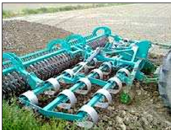
Fig. 8. Grada preparatoria del terreno.
