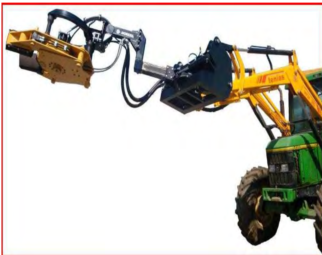
FIG. 5.10. Tractor amb vibrador d'olives.
