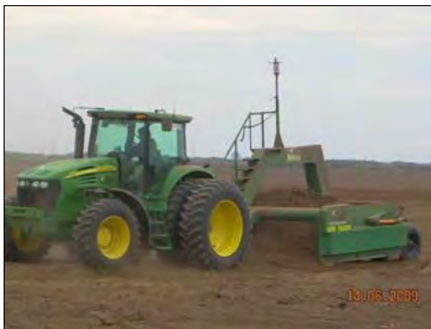
FIG. 13.7. Tractor agrícola amb equip d'anivellació làser.
