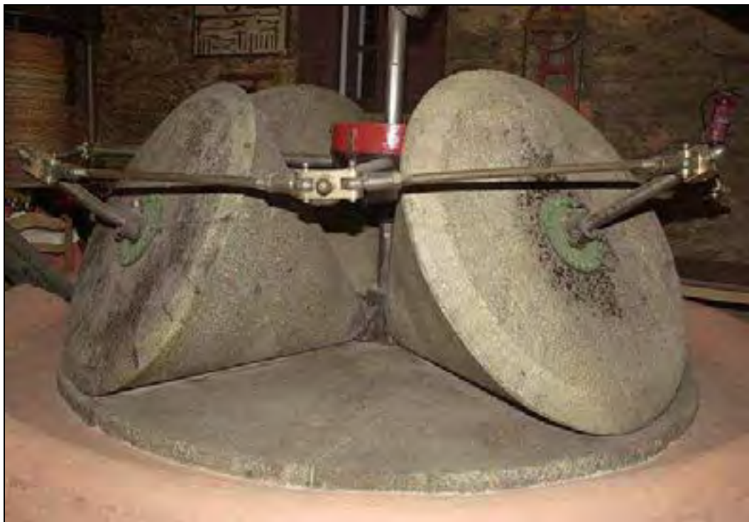
FIG. 10.3. Molí de tres curres i tracció elèctrica.
