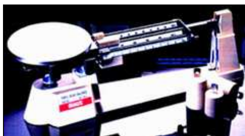
Fig. 24. Balanza con error de 1 gramo.
