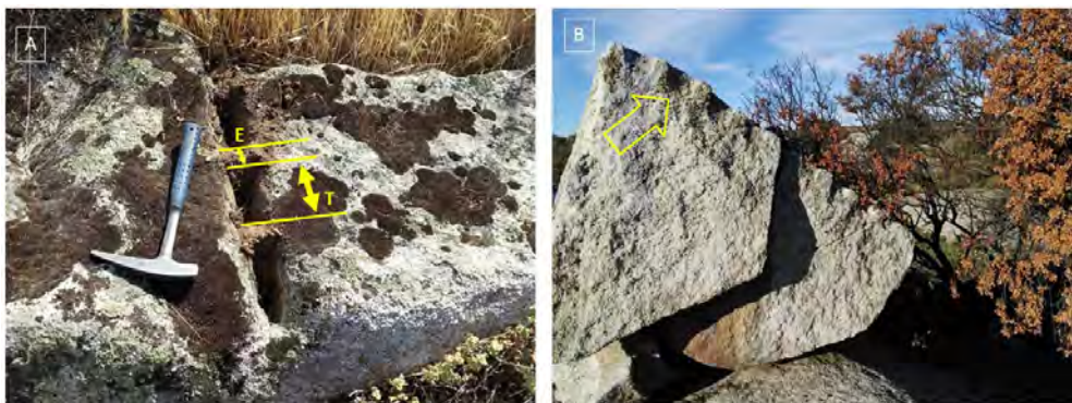
FIGURA 12. IMPRONTAS HISTÓRICAS DEL EMPLEO DE CUÑAS PARA EL CORTE Y ARRANQUE DEL MATERIAL. A: SECTOR N, TAMAÑO O LONGITUD DE LAS CUÑAS (T), ESPACIADO ENTRE ELLAS (E) Y NÚMERO DE CUÑAS EN UNA LABOR, EN ESTE CASO TRES, B: SECTOR S, EMPLEO DE CUÑAS DE GRAN TAMAÑO (20 CM) PARA EL CORTE DE UN BOLO GRANÍTICO. Fotos: los autores
