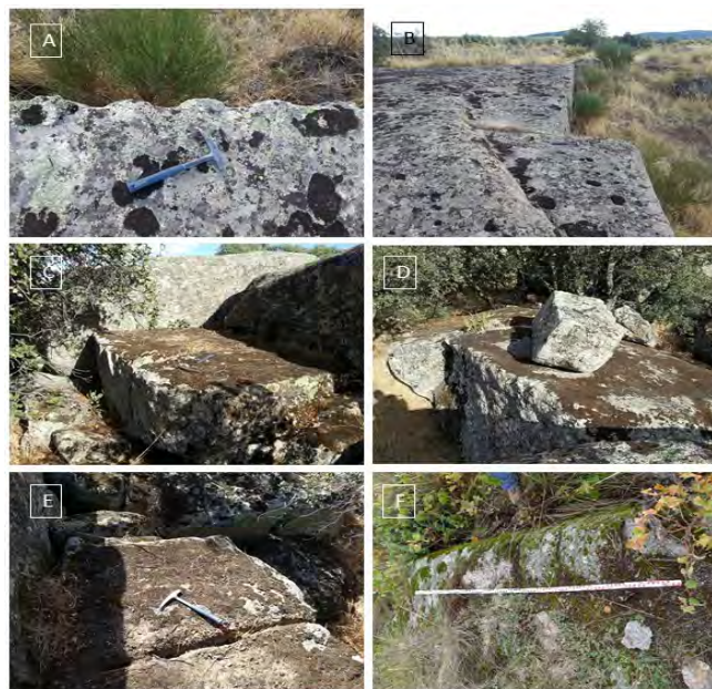
FIGURA 4. ÁREA NE, SECTOR S. A: IMPRONTAS DEL EMPLEO DE CUÑAS EN EL FRENTE DE EXPLOTACIÓN, B: FRENTES DE EXPLOTACIÓN, C: SILLARES TALLADOS Y ADOSADOS AL MACIZO ROCOSO, D: SILLARES EXENTOS EN EL ÁREA DE EXPLOTACIÓN, E: SILLAR TALLADO SIN EXTRAER DEL MACIZO ROCOSO, F: ROZAS EN EL MACIZO ROCOSO, SECTORIZANDO LOS BLOQUES PARA SU POSTERIOR TALLADO Y EXTRACCIÓN. Fotos: los autores
