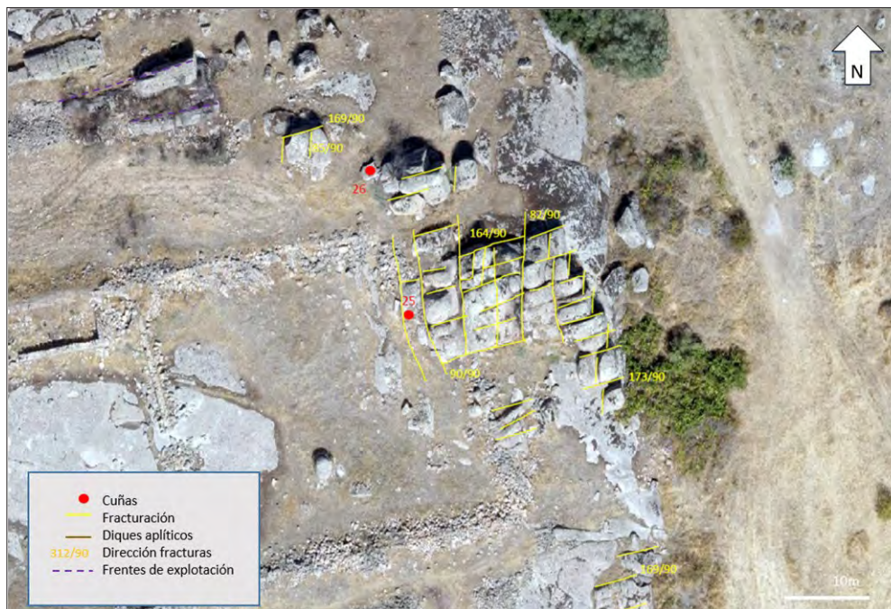
FIGURA 8. ORTOIMAGEN DEL ÁREA NE, SECTOR N, EN LA CUAL SE OBSERVA LA DENSIDAD DEL DIACLASADO. Fotos: los autores
