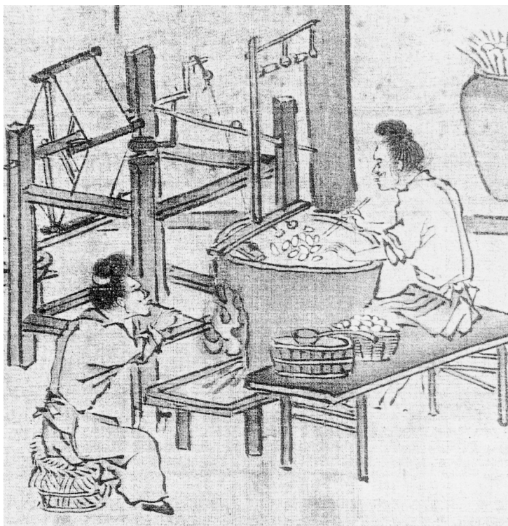
Fig. 3. Devanadera de aspas 8 , que permitía ir formando madejas de hilo de seda en paralelo. Dibujo realizado sobre seda por el pintor Liang Kai, de mediados del siglo XIII. (Museo de Arte en Cleveland).
