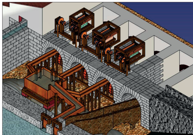
FIGURA 12. VISTA DEL CONJUNTO HIDRÁULICO Y MECÁNICO DEL MOLINO DE MÁRMOL. Fuente: F. V. Sánchez Martínez
