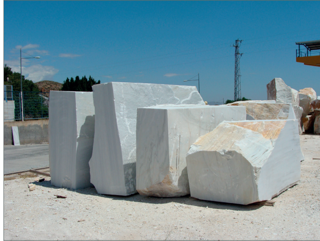
FIGURA 6. BLOQUES DE MÁRMOL BLANCO DE MACAEL. Foto: A. Carretero Gómez
