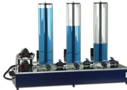
Figura 1. El sistema de tres tanques de Amira.
