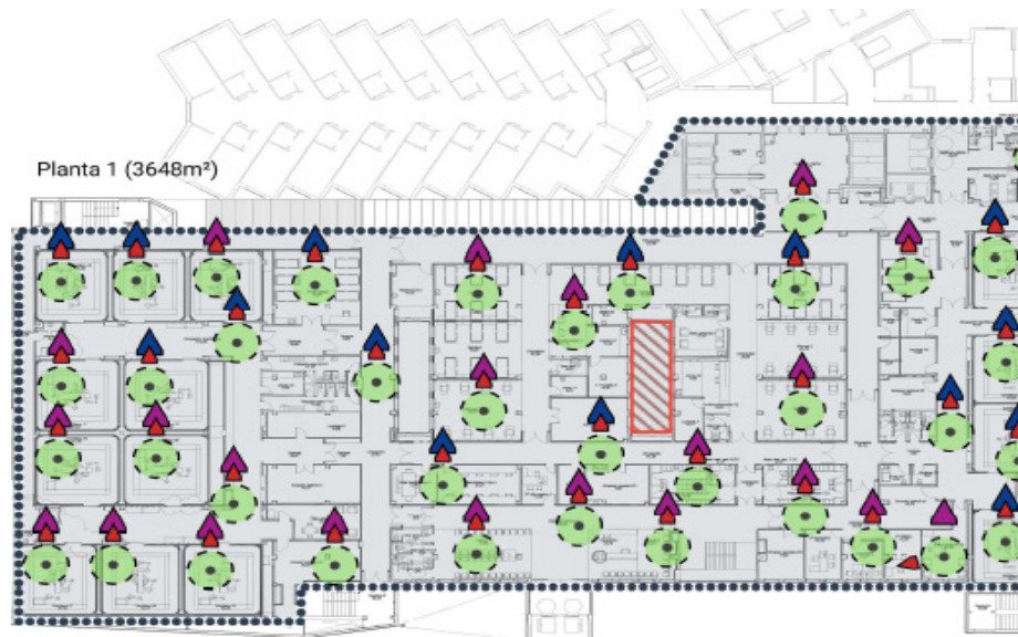
Ilustración 6: Estudio de cobertura sobre plano para implantación de red inalámbrica
